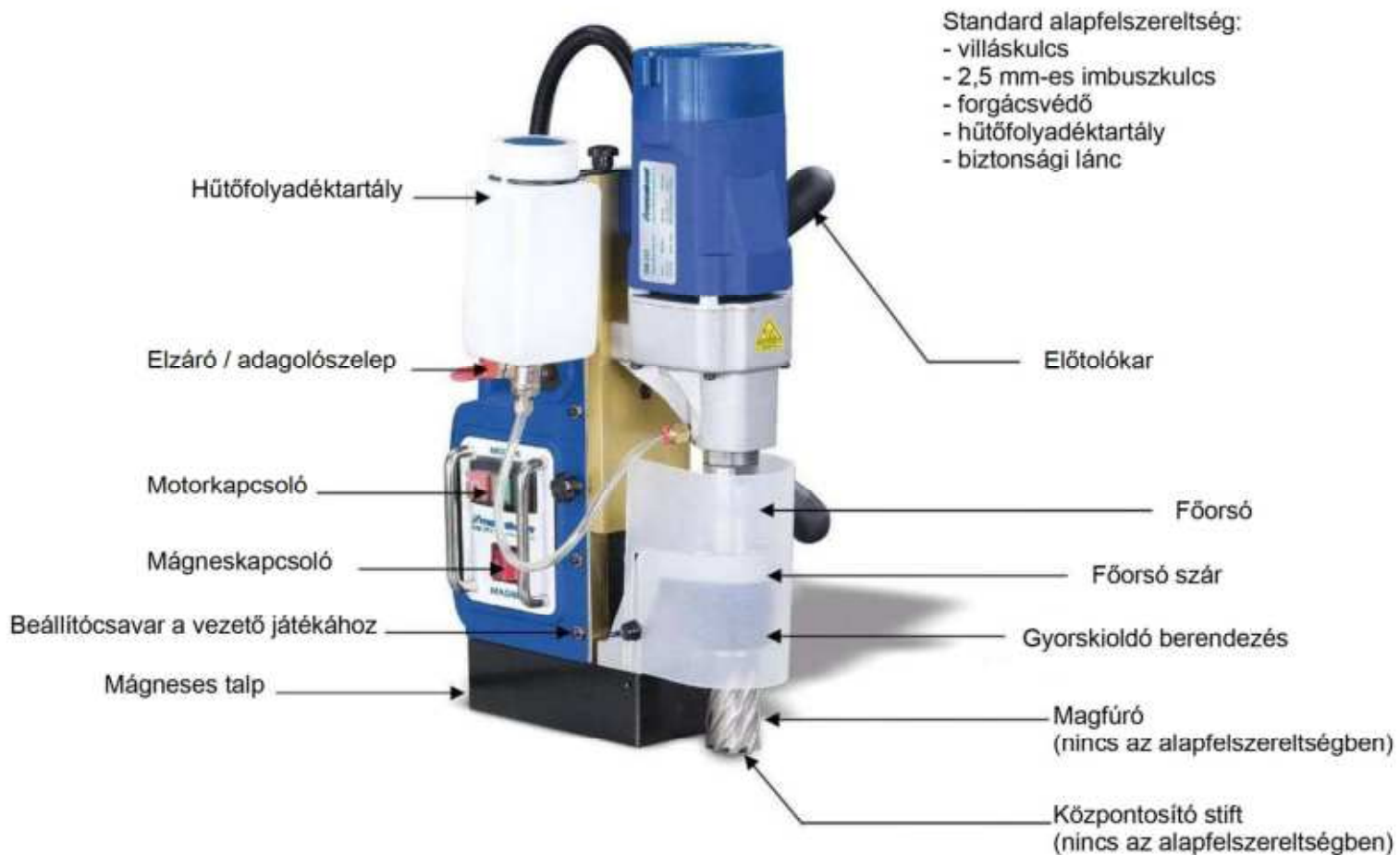
4. ábra: Az MB 351 mágneses talpas fúrógép kezelőelemei
