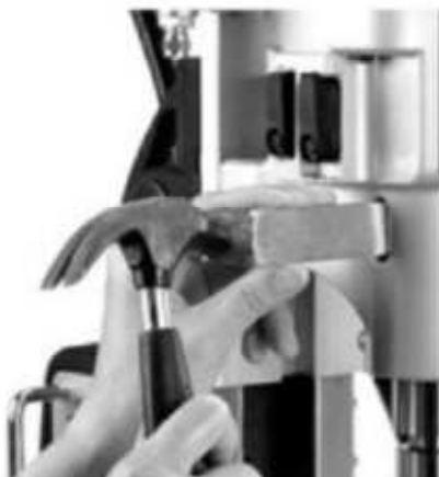
17.ábra: A szerszám kilazítása
