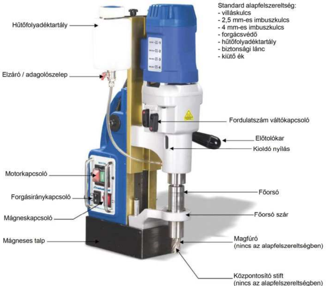
7. ábra: Az MB 754 mágneses talpas fúrógép kezelőelemei
