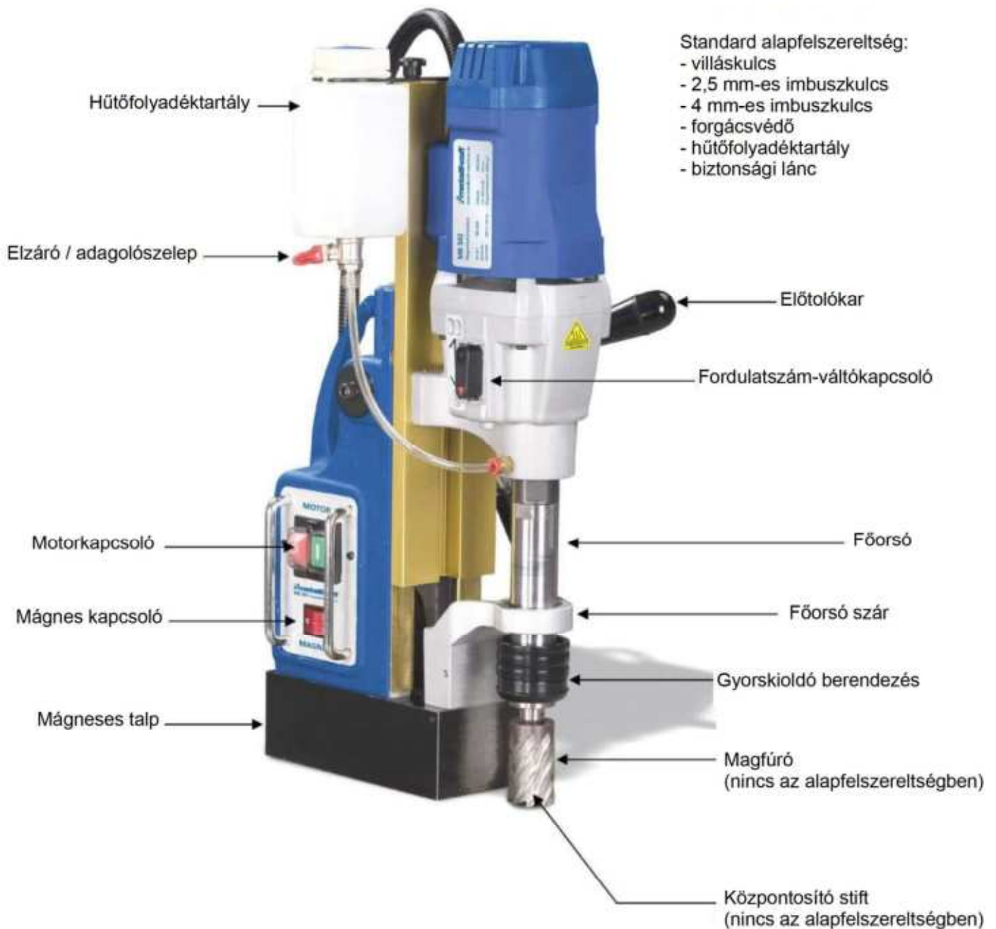
5. ábra: Az MB 502 mágnes talpas fűrőgép kezelőelemei
