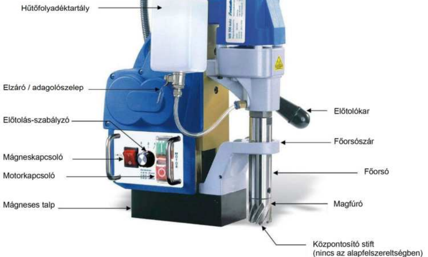
3.ábra: Az MB 301 Auto mágneses talpas fűrőgép kezelőelemei
