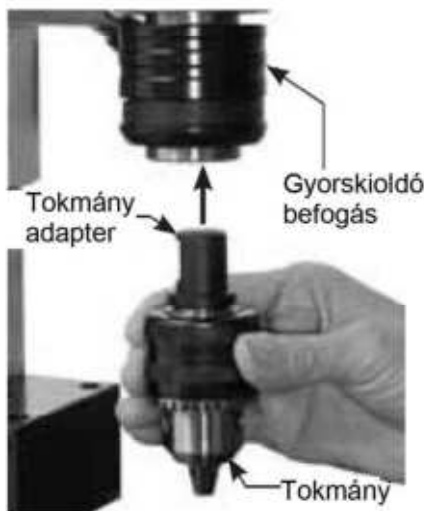
16.ábra: A tokmány szerelése a gyorskioldó berendezésnél
