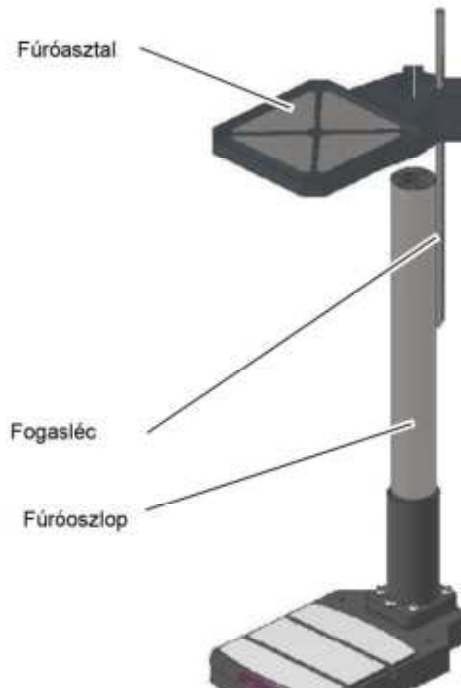
4-3. ábra: A fúróasztal összeállítása
