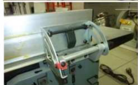
19. ábra: A ferde vezető beállítása
