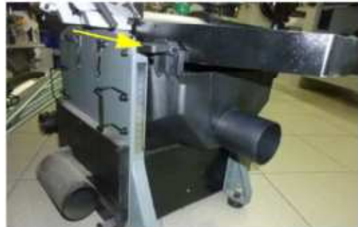
18. ábra: A forgácselszívó felszerelése
