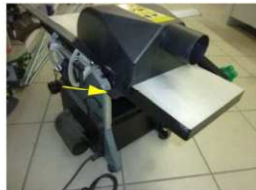
22. ábra: A forgácselszívó felszerelése
