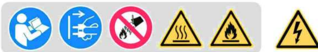
1-1. ábra: Biztonsági jelölések (balról: Tartsa be a kezelési útmutatót!, Az elektromos csatlakozónál fogva húzza ki!, Vízrel oltani tilos!, Forró felületre figyelmeztetés!, Nyílt láng használata tilos!, Elektromos feszültségre figyelmeztetés!)
